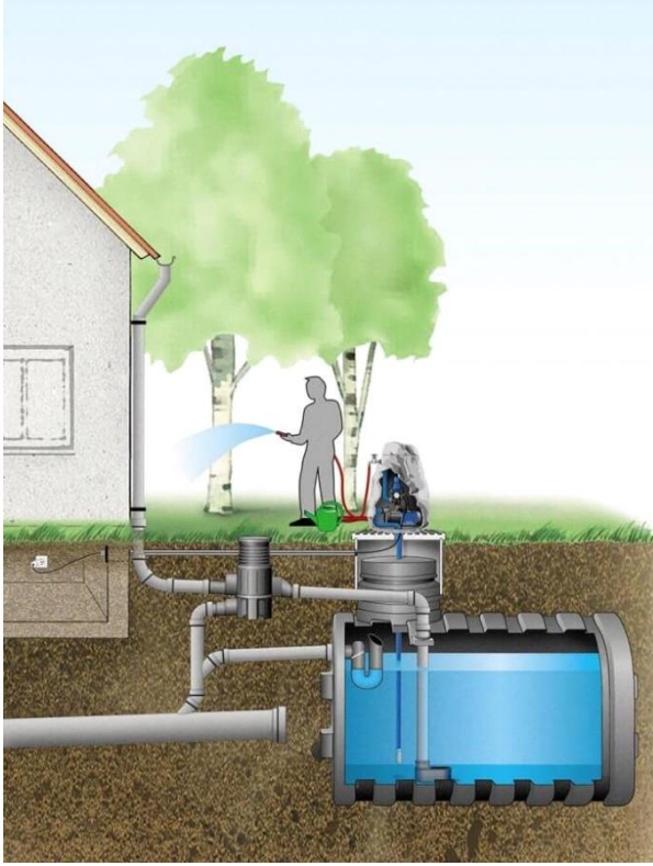
Şekil 1. Yağmur suyunun çatılardan toprak altı depoya toplanması
