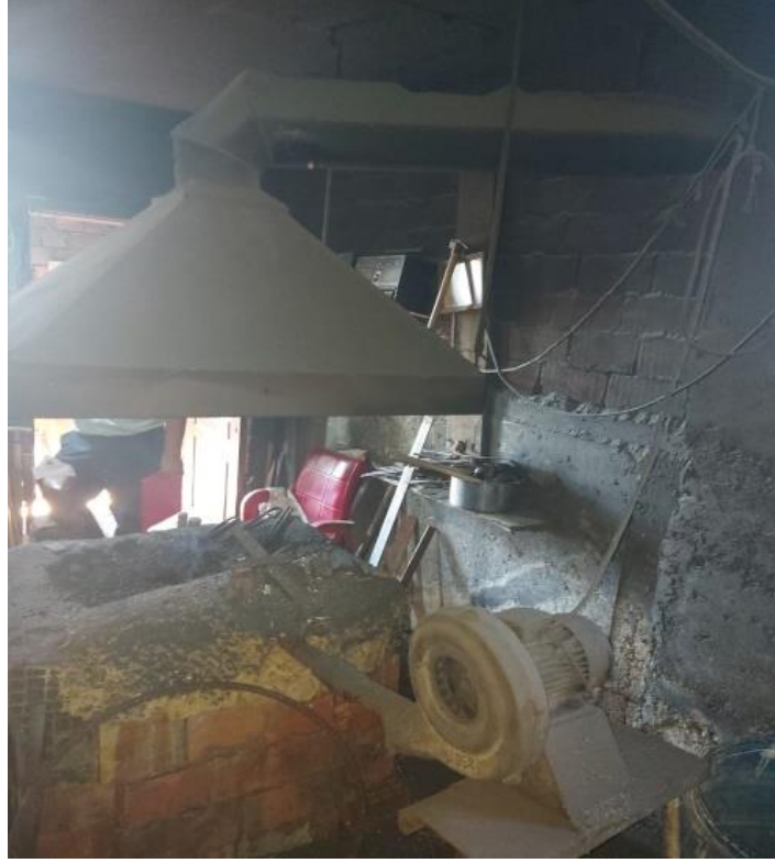
Fotoğraf 7: Elektrikle çalışan körük sistemi
